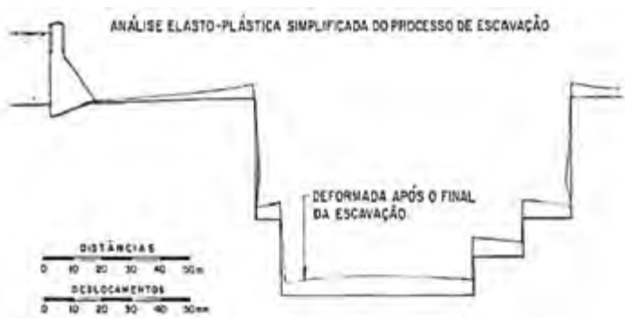
Figura 2 – Previsão de deslocamentos ao término das escavações (Nieble & outros, 1987)
