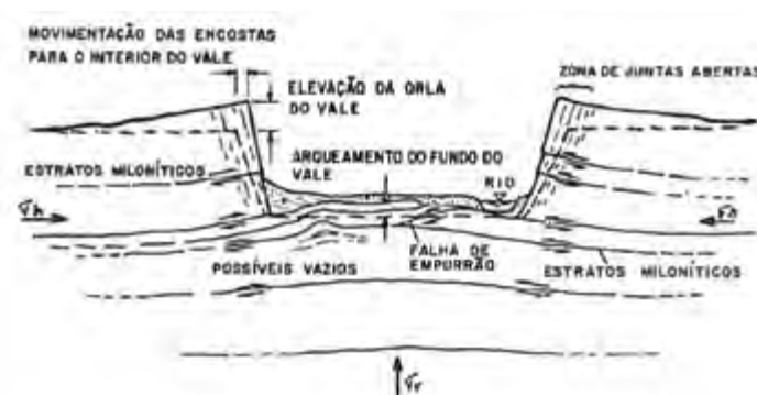
Figura 4 – Estruturas relacionadas com o alívio de tensões em vales fluviais, em rochas acamadas (Patton & Hendron, 1974)
