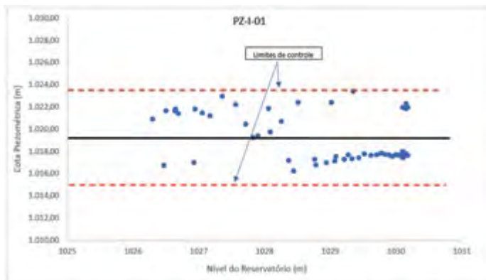
Figura 4 – Gráfico piezômetro inclinado na crista
