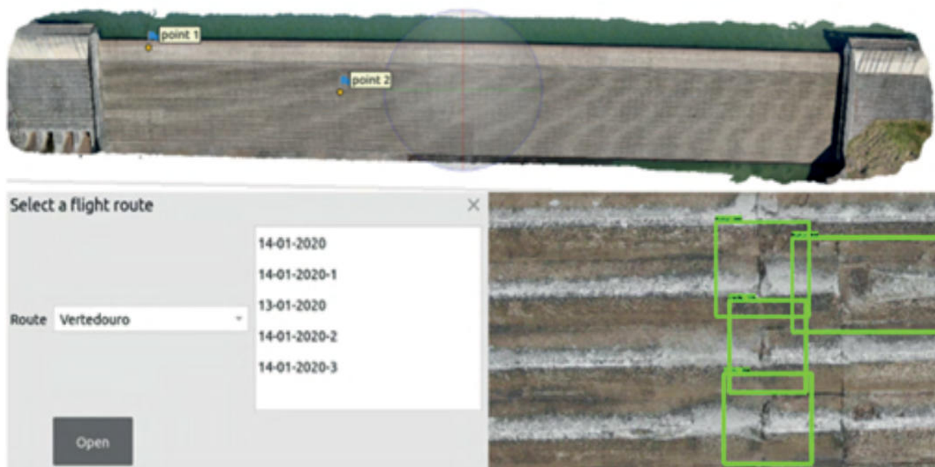
FIGURA 10 – Mapa 3D e sinalização de danos no vertedouro
